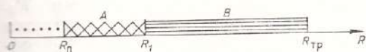
Рис. 1. Схематическое изображение различных зон в среде после взрыва в случае, когда щель отсутствует. Полость ( R \geq R_п ): A — зона раздавливания ( R_п < R < R_1 ); B — зона радиальных трещин ( R_1 < R < R_тр ).
