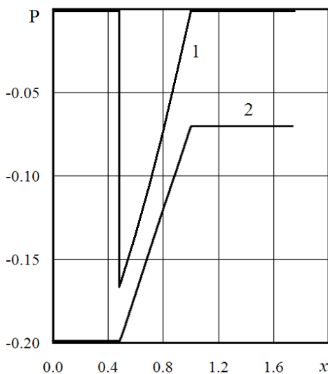
Рис. 7.35. Задача 12. Зависимости 1 – P(x) и 2 – \rho(x) в момент разрушения t_{\sigma}=1
