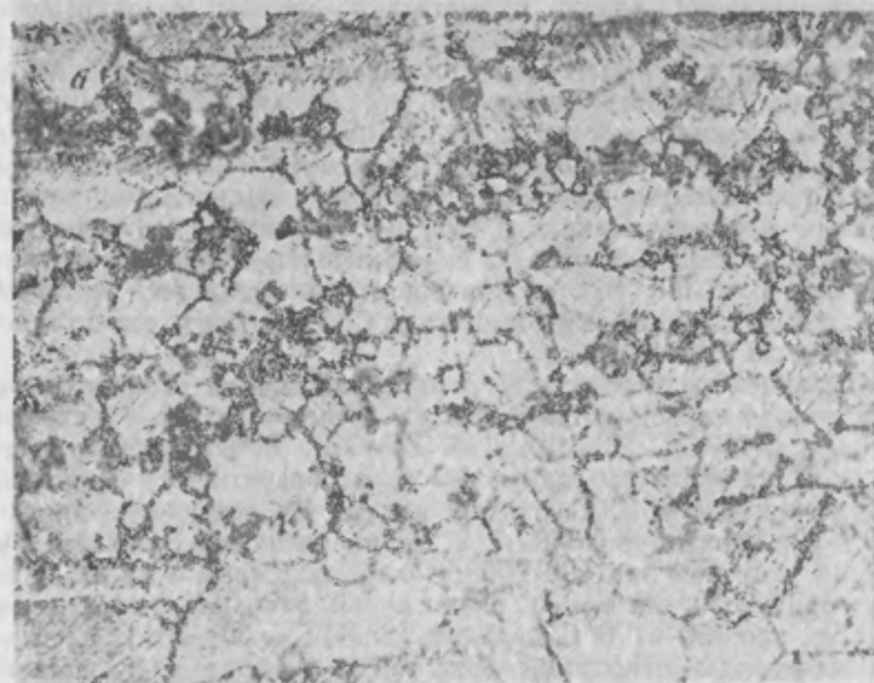
Рис. 5.12. Микроструктура стали 12X18N10T после нагружения ударной волной и последующей разгрузки. Время действия растягивающих напряжений t_0 = 1.3 \cdot 10^{-6} с. Увеличение 500\times . Начальная температура образца и напряжение на ударной волне: а — T = 0^\circ\text{C} , \sigma_{xx} = 4 ГПа; б — T = -196 С, \sigma_{xx} = 6.9 ГПа.
