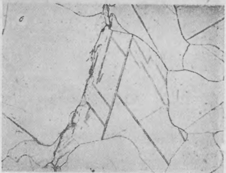
Рис. 5.11. Микроструктура армо-железа после нагружения ударной волной с \sigma_{\text{шк}} = 2.8 ГПа и начальной температурой T = 800 (а) и -196 °С (б). Увеличение 500\times .
